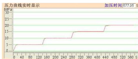
图11 加压过程保压实验升压曲线
